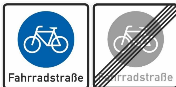
Abb. 4: VZ 244.1 „Beginn einer Fahrradstraße“ und VZ 244.2 „Ende einer Fahrradstraße“ Quelle: AGFS (2023), Leitfaden Fahrradstraßen, 2.5.
