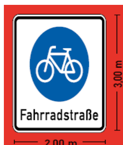
Abb. 5: Prinzipskizze des Piktogramms „Beginn einer Fahrradstraße“ auf Rotmarkierung Quelle: AGFS (2023), Leitfaden Fahrradstraßen, 2.11.
