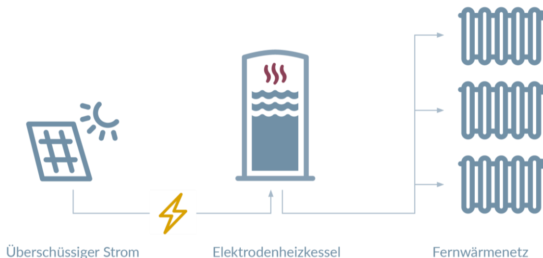
Abbildung 3-10: Funktionsweise Elektrodenheizkessel (Quelle: eigene Darstellung)
