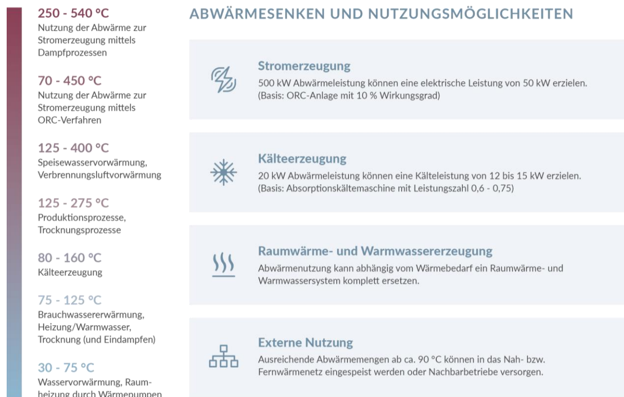
Abbildung 3-9: Nutzung von industrieller und gewerblicher Abwärme in Abhängigkeit vom Temperaturniveau (Quelle: eigene Darstellung in Anlehnung an dena)
